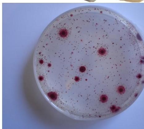
Con este práctico medio de MICROKIT, distinguirá a simple vista las colonias, rojas, de las partículas de muestra y del medio, agilizando los recuentos sin desgastar su vista. Y en mucho menos tiempo. Arriba, siembra en superficie; abajo, siembra en masa
